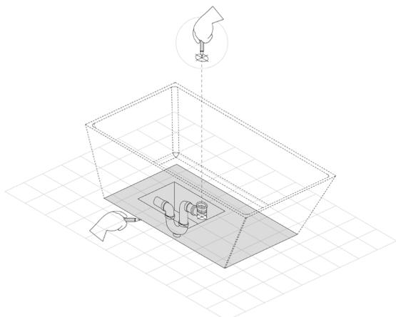
4. Avec la cuve toujours en place, marquez l'emplacement et le point central de la sortie du drain de vidange.
