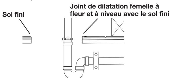
9. Installez le drain de vidange de la baignoire et raccorder le joint de dilatation mâle, en veillant à laisser une longueur suffisante pour le connecter solidement au joint de dilatation femelle sous le sol.
