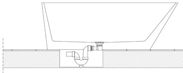
12. Remplissez la baignoire d'eau pour vérifier que toute l'eau s'écoule librement par le drain de vidange.
