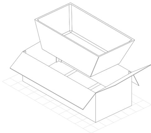
2. Placez la baignoire à l'endroit désiré dans la salle de bains. Faites attention au choix de l'emplacement de la baignoire pour s'assurer que le drain de vidange et la plomberie ne sont pas situés directement au-dessus des solives du sol.
