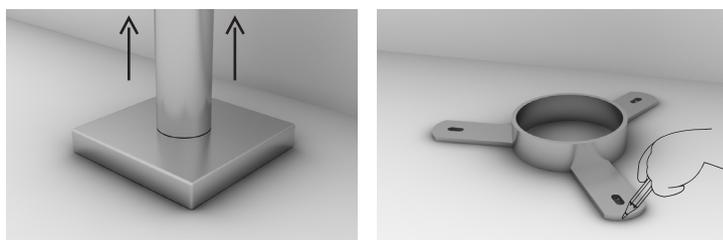
Placez l'ancre de colonne dans sa position confirmée et procédez à marquer avec un stylo ou un crayon les emplacements des vis.
