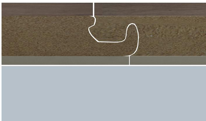
7. Avec un petit morceau de stratifié, appuyer légèrement pour s'assurer que la languette et la rainure des pièces installées restent à niveau et alignées. Utilisez une cale de frappe pour taper contre les planches verrouillées jusqu'à ce que les joints d'extrémité se ferment en formant une ligne de jointure perpendiculaire.
